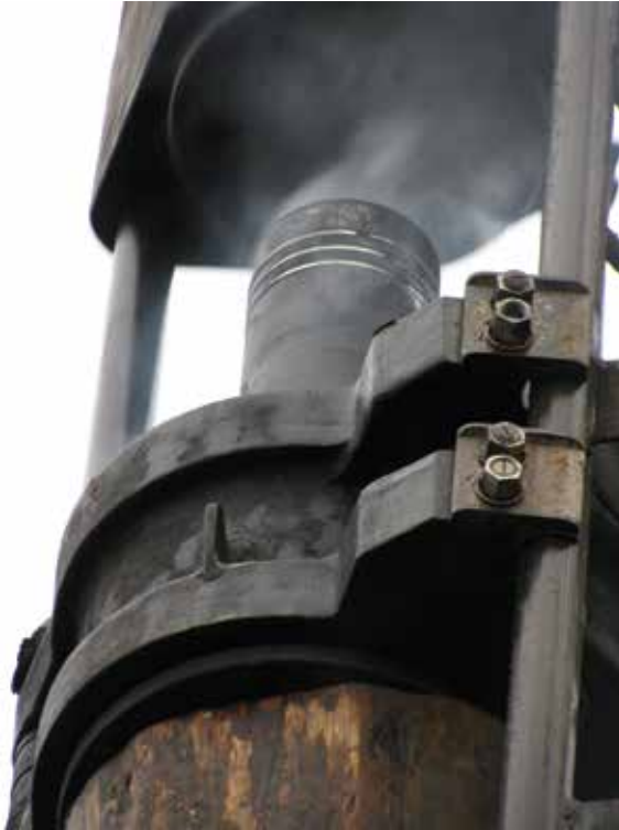
En eksplosjon nederst i blokka gjør at loddet blir kastet opp ca. 1 meter før det igjen faller ned på blokka.
