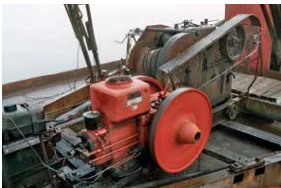
Pålebukken, motoren og vinsjen er montert på en stålpram.
