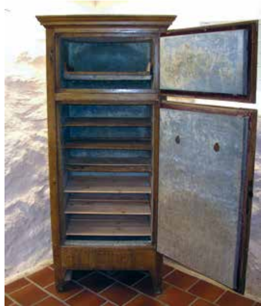
Isskapet i Bestyrerboligen er kledd med sink innvendig for å holde på kulden og hindre kondens. Foto: Fetsund lenser.
