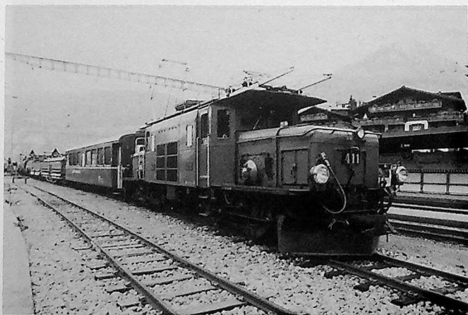
Underveis- godstoget Landquart- Davos i Klosters, aug. 1988, trukket av en av de be- rømte "krokodillene" Lok 411 type Ge 6/16 I
