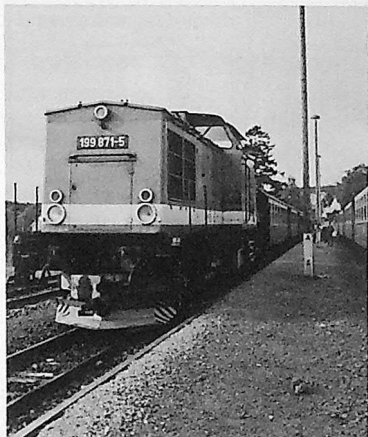
Diesellok tas nå i bruk på smalsporet i Harz. Det er normalsporkort av type 110 som får tre-akslede bogger. Her 199 871 i Elend. Lokene virker litt overdimensjonerte på smalsporet... (Kjell Navestad)
