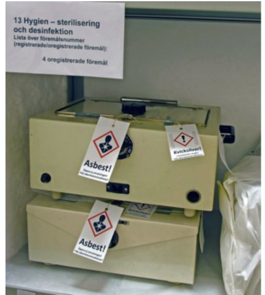
Eksempel på tydelig merking av ett objekt som inneholder kvikksølv og asbest. Foto: Thomas Gütebier.
