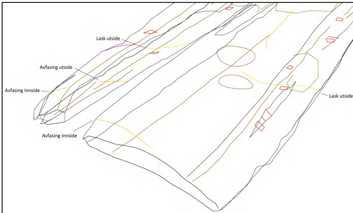
Figur 52. Hudbord x004 ende forut med overlapp til hudbord x003 med avfasing. Oransje linje er avfasing. Den er tydeligst på innside, men det er også rest av avfasing på utside. Gul linje er lask på utside forut.
