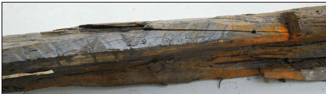
Figur 51. Akterdel av kjøl x001. Uthogg til stråkjøl med huggspor.
