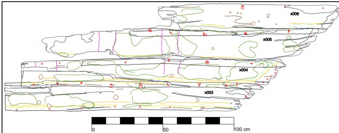
Figur 54. Overlapp mellom bordganger. Oransje linje er skråkant og gul linje er su. Flere av hudbordene var skadet slik at sua ikke kunne dokumenteres.
