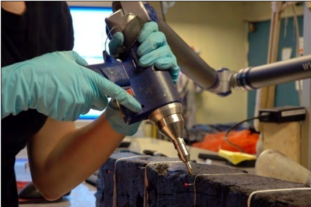
Figur 3 FARO-armens målespiss med pistolgrep i bruk. Ved å taste rød eller grønn knapp mens man holder spissen stødig mot objektet, velger man hvor punktet skal settes.
