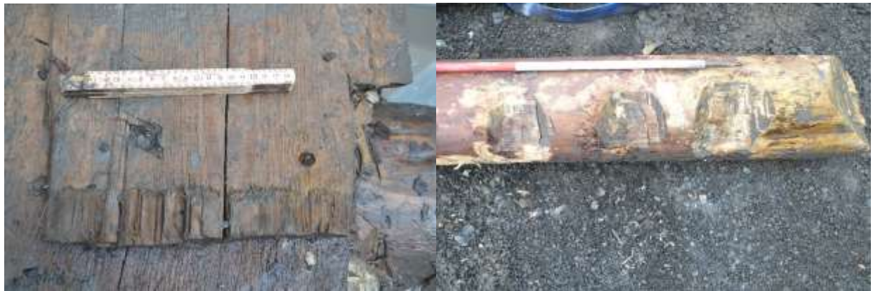
Figur 61: Til venstre er en oppgangsskjært planke fra K2002. Til høyre er eksempel på uthogg på undersiden av stokk for tilpasning til stokker i «bunnflåte». Foto NMM.
