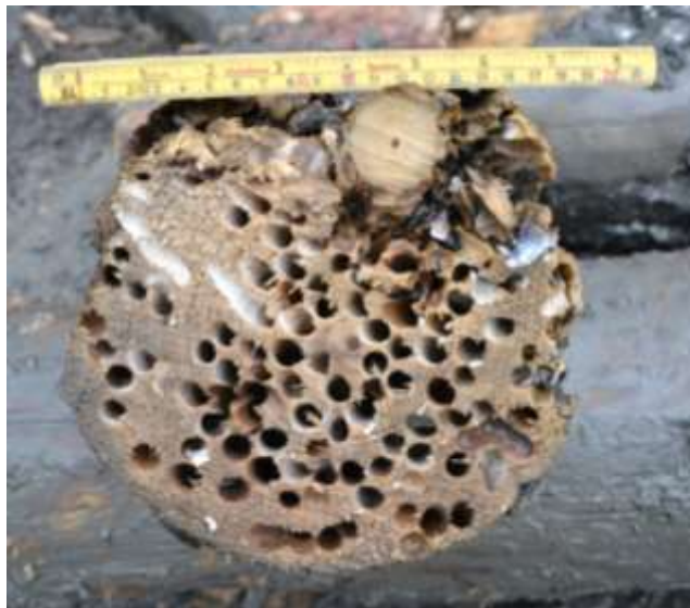
Figur 64: Spor etter pelemarkangrep, laftekasse K2000, stokk 2. Foto NMM.
