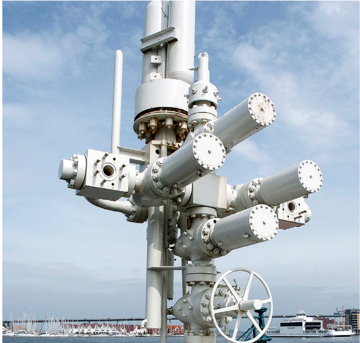
Gjennom dette ventiltreet strømmet den første norske olje og gass. Ventiltreet var i bruk fra 1971 til 1975 i brønn AX_1 på Ekofisk og stod plassert på havbunnen. I denne perioden produserte brønnen verdier for 14 milliarder kroner i 1982-priser. Foto: Jan A. Tjemsland, Norsk oljemuseum
