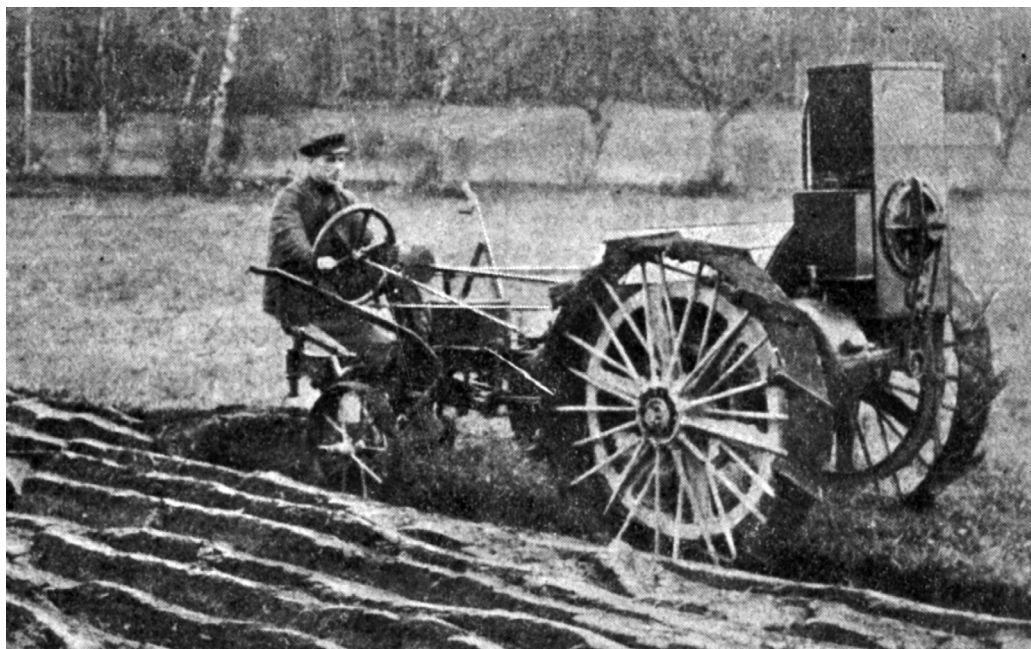
Den norskproduserte motorploegen Gideon. Motorplog var en vanlig betegnelse her i landet på de aller første traktorene.
