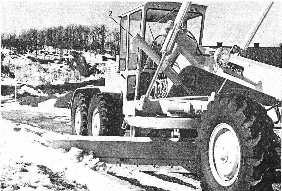
Bild 8. För att undvika överbelastning av hyvelbladet vid upprivning av hårdare material skall följande iakttas: Dra in sidoförskjutningscylinders kolvstång, pos. 2, så att 3—400 mm kvarstår, skjut därefter ut hyvelbladet ca 2/3 av bladförskjutningscylinders totala slaglängd.
