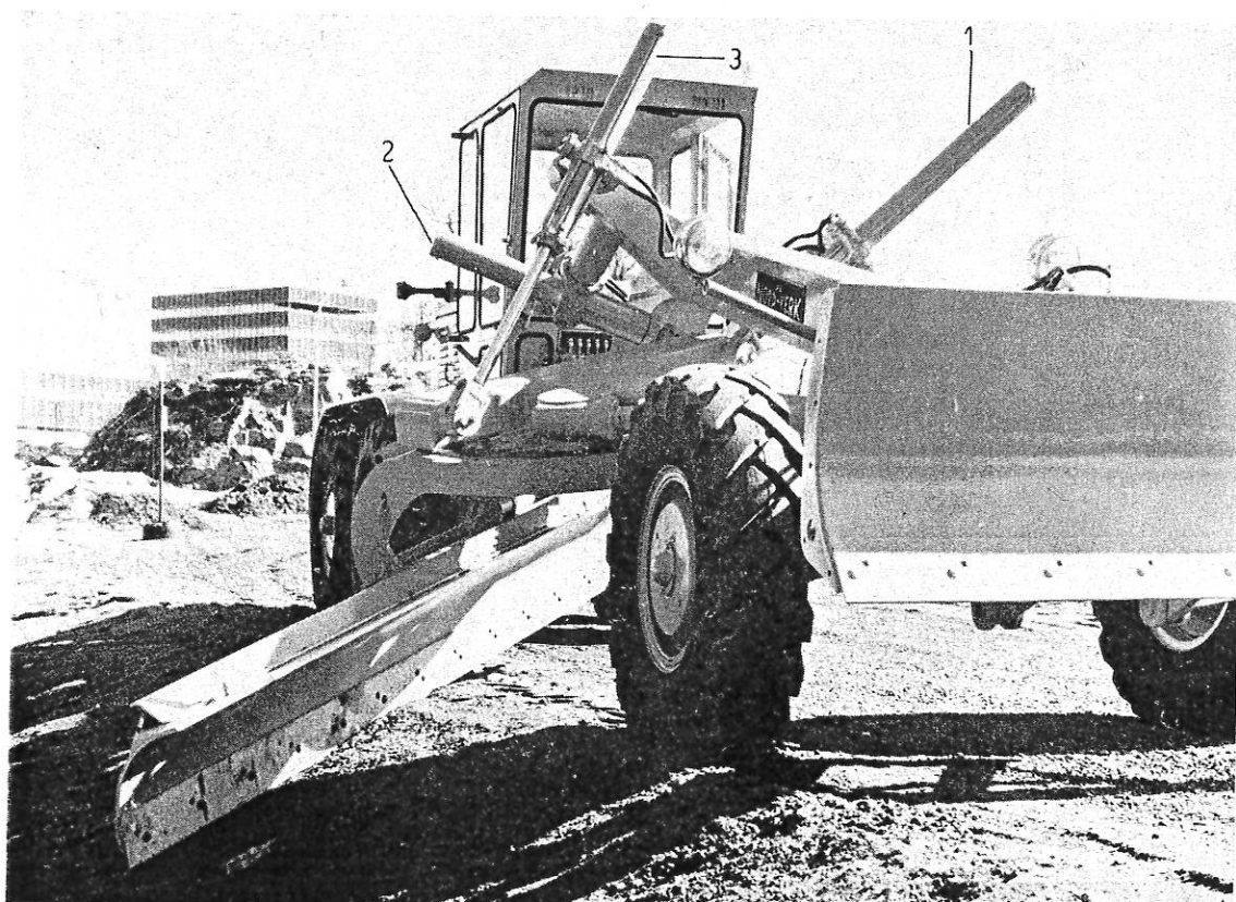
Bild 6. Dra in sidoförskjutningscyllindern helt, pos. 2, skjut ut höger lyftcylinder, pos. 3, drag samtidigt in vänster lyftcylinder, pos. 1. Se även bild 7.
