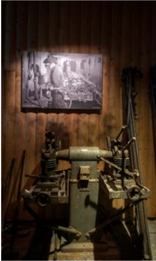
Bilde fra Vinstra-utbyggingen viser utstyr for bor-kvessing slik det ble gjort da mekanikerne overtok for smeden ved innføring av hardmetall-skjær. (Foto: Morten Reiten)
