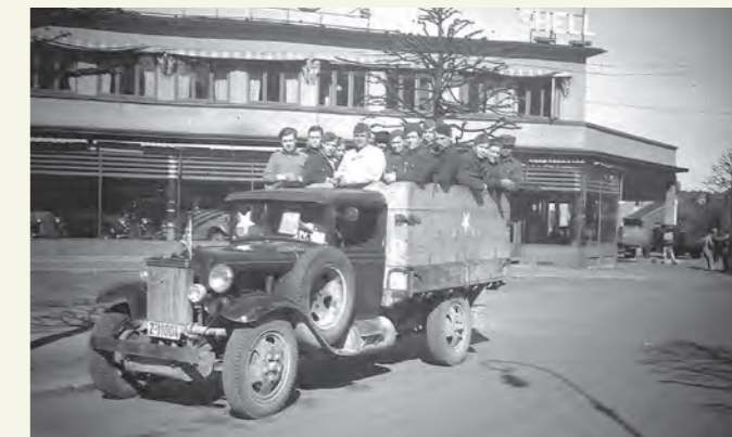
FRIGJØRINGEN 1945: Generatordrevet lastebil i alliert tjeneste reiste rundt og samlet inn sovjetiske krigsfanger i Tønsberg. Her utenfor Bergans Auto i Stoltenbergs gate. FOTO: Stangebye
