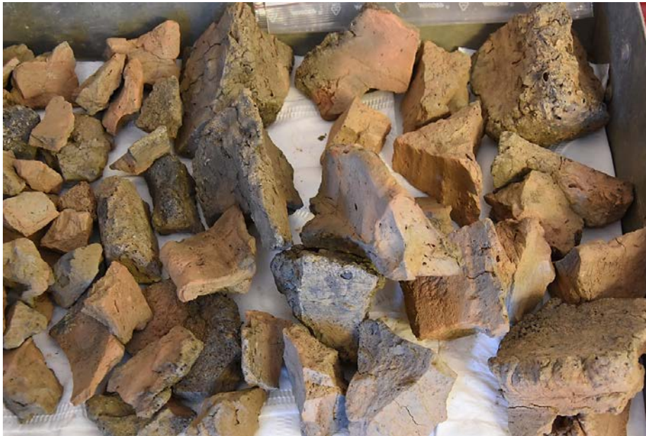
Fig. 20. Analys av lerklining i olika former kan ge information om husets konstruktionsdetaljer.
